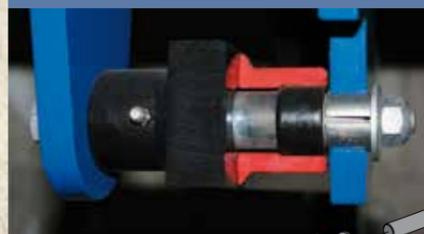
Tous les points de fixation ou d'articulation importants sont équipés du système „LockPin“. Principe : Une broche remplace les vis ou axes traditionnels. Des douilles de grande qualité sont insérées sur les bouts en forme de cônes de l'axe. Une vis permet de serrer les douilles sur les axes permettant ainsi une articulation sans jeu.
