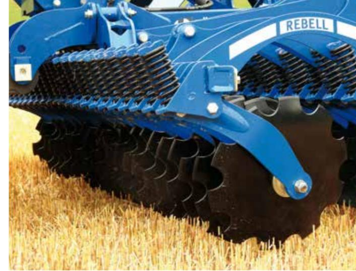
**Disques suspendus montés sur lames ressort ou sur ressorts hélicoïdaux**
