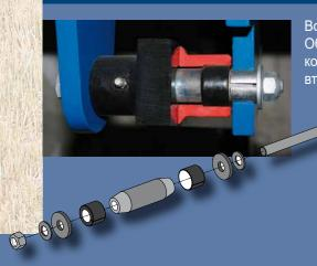
Все важные узлы крепления соединенны болтами системы «ЛокПин». Принцип: Обычное соединение пальцами заменяется системой "ЛокПин". На конусные концы оси вставляются высококачественные втулки. С помощью болта втулки втягиваются, спресовываются и фиксируются в кронштейне.
