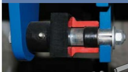
Все важные узлы крепления соединены болтами системы «ЛокПин». Принцип: Обычное соединение пальцами заменяется системой „ЛокПин“. На конусные концы оси вставляются высококачественные втулки. С помощью болта втулки втягиваются, спрессовываются и фиксируются в кронштейне.
