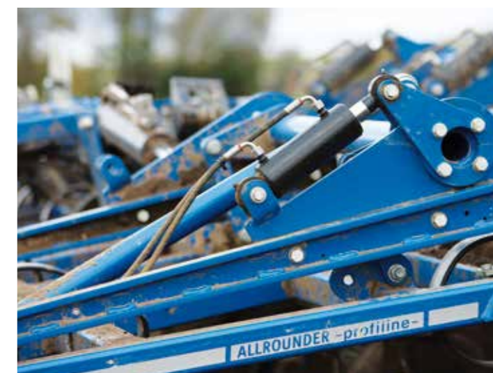
Гидравлическая настройка глубины
