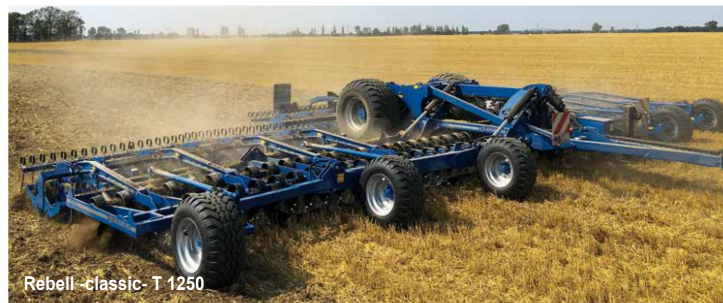
Стойки из спиральной пружины
