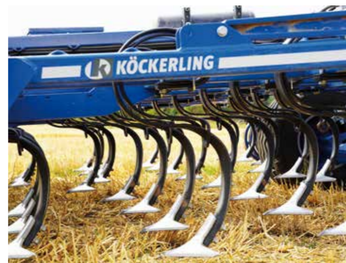
Стойка Геркулес Плюс + двойная пружина
