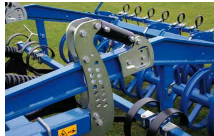
Гидравлическая настройка глубины
