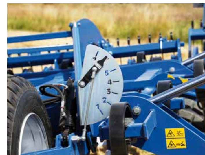
Гидравлическая настройка глубины
