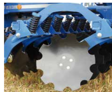
Стойки из спиральной пружины
