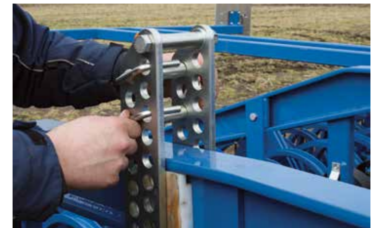
Механическая настройка глубины
