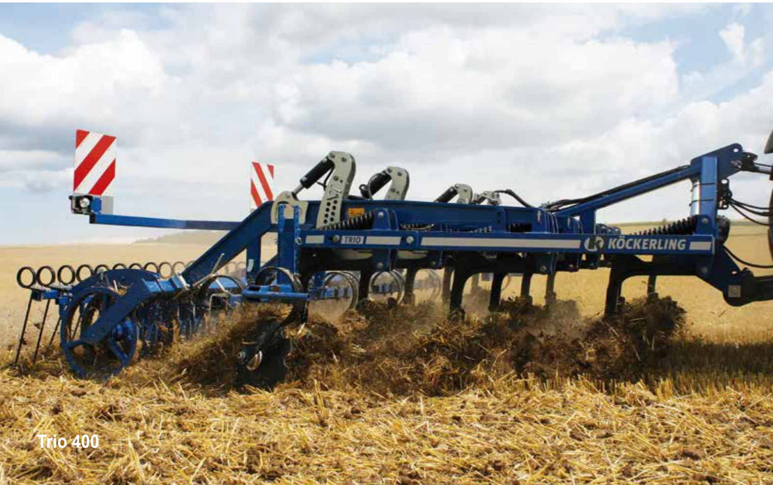
Гидравлическая настройка глубины
