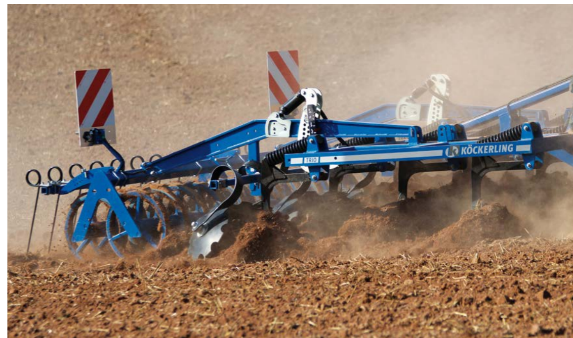
Trio 300 двойной DSTS каток, дисковый нивелятор и блок защиты
