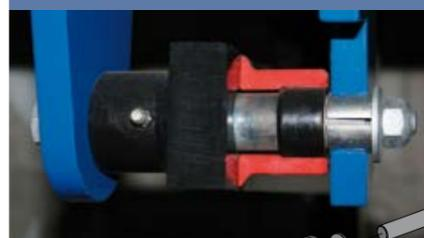
Все важные узлы крепления соединены болтами системы «ЛокПин». Принцип: Обычное соединение пальцами заменяется системой „ЛокПин“. На конусные концы оси вставляются высококачественные втулки. С помощью болта втулки втягиваются, спрессовываются и фиксируются в кронштейне.
