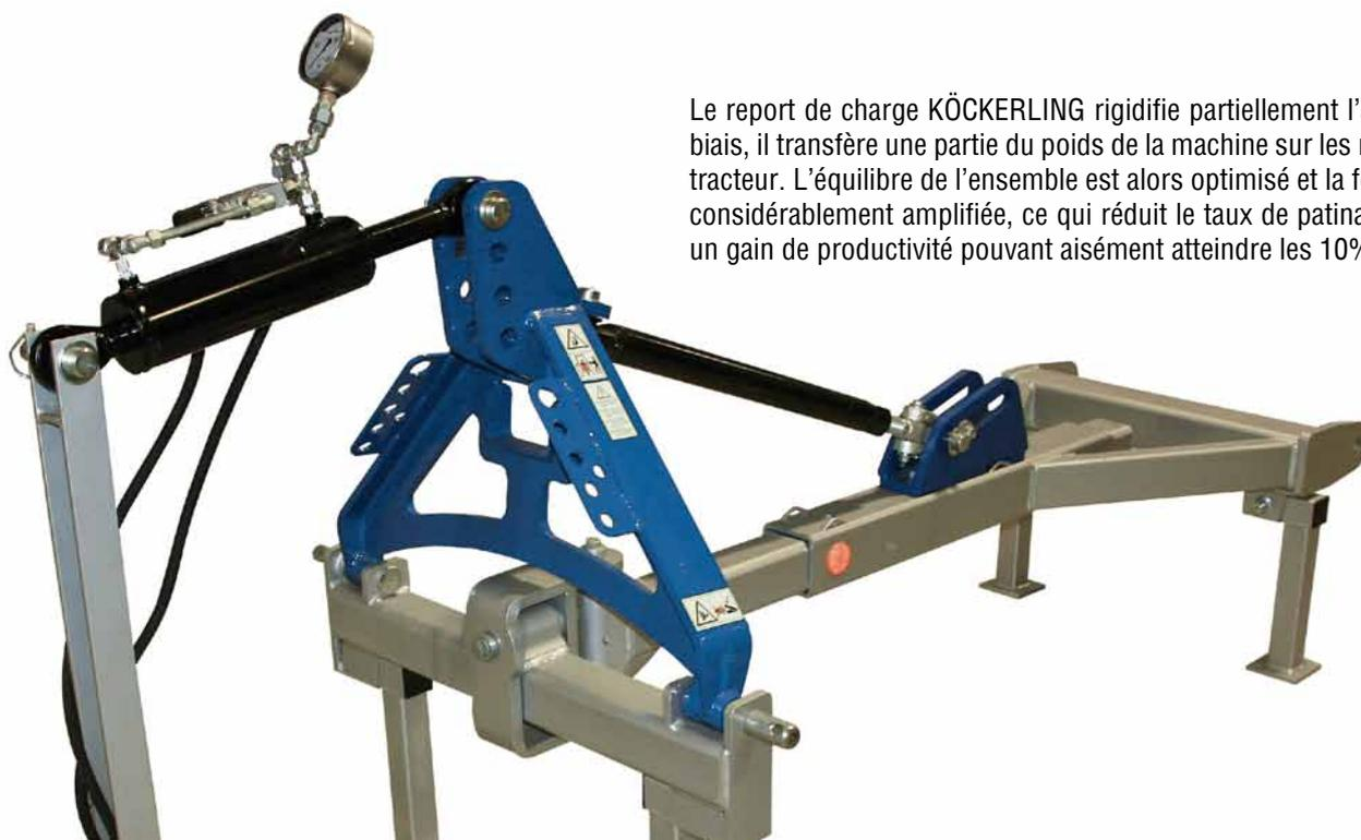
Le report de charge KÖCKERLING rigidifie partiellement l'attelage. Par ce biais, il transfère une partie du poids de la machine sur les roues arrière du tracteur. L'équilibre de l'ensemble est alors optimisé et la force de traction considérablement amplifiée, ce qui réduit le taux de patinage et engendre un gain de productivité pouvant aisément atteindre les 10%.
