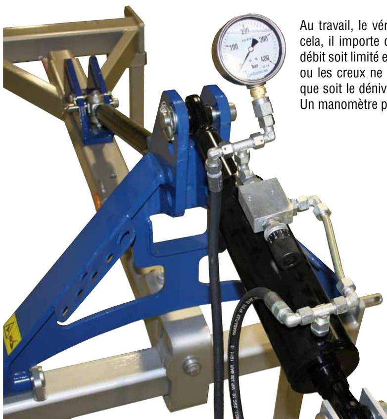
Au travail, le vérin hydraulique est activé par le distributeur du tracteur. Pour cela, il importe que le distributeur soit activé en pompage continu et que son débit soit limité entre 5 et 10l/min. Les irrégularités du terrain telles que les butes ou les creux ne gêneront en rien le fonctionnement du report de charge. Quel que soit le dénivelé, la pression et l'efficacité du système resteront constantes. Un manomètre permet de contrôler la pression hydraulique et facilite le réglage.
