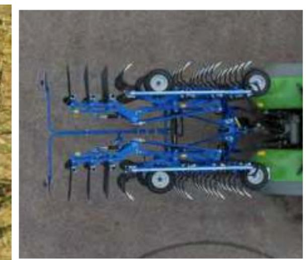
La tête de répartition fixée solidement sur le châssis de l'Allrounder Classic, permet une modularité du système de semis en fonction des besoins. Il est possible d'effectuer un semis à la dent ou à la volée avec des descentes situées devant le rouleau ou devant la herse peignes. Pour plus de polyvalence, une seconde tête de répartition peut être fixée à l'arrière afin de réaliser des associations de cultures ou appliquer un hélicide.
