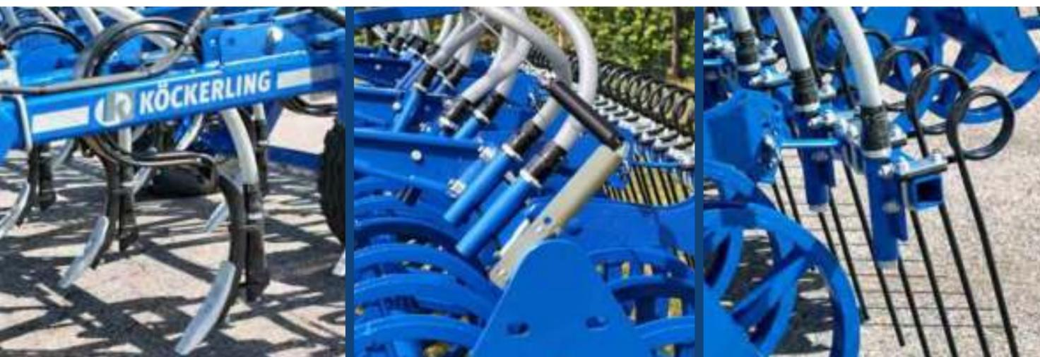
La tête de répartition fixée solidement sur le châssis de l'Allrounder Profiline, permet une modularité du système de semis en fonction des besoins. Il est possible d'effectuer un semis à la dents ou à la volée avec des descentes situées devant le rouleau ou devant la herse peignes. Pour plus de polyvalence, une seconde tête de répartition peut être fixée à l'arrière afin de réaliser des associations de cultures ou appliquer un hélicide.
