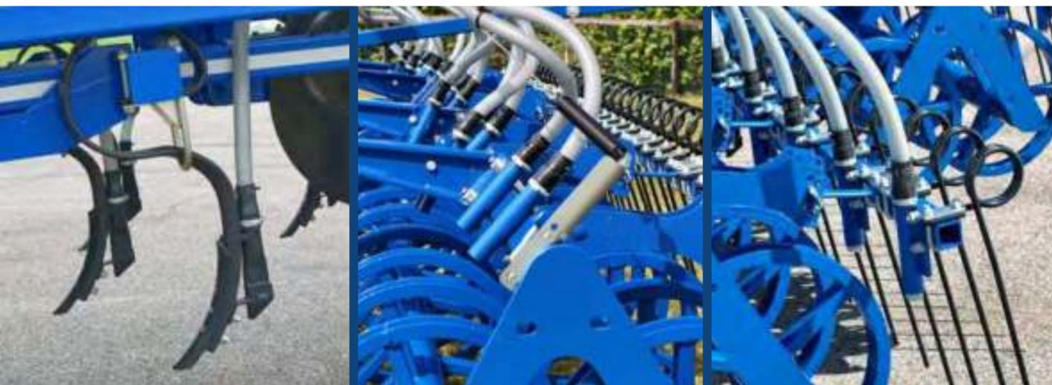
La tête de répartition fixée solidement sur le châssis de l'Allrounder, permet une modularité du système de semis en fonction des besoins. Il est possible d'effectuer un semis à la dent ou à la volée avec des descentes situées devant le rouleau ou devant la herse peigne. Pour plus de polyvalence, une seconde tête de répartition peut être fixée à l'arrière afin de réaliser des associations de cultures ou appliquer un hélicide.
