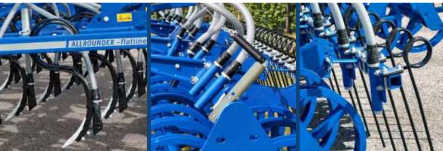
Les têtes de répartition fixées solidement sur le châssis de l'Allrounder Flatline, permettent une modularité du système de semis en fonction des besoins. Il est possible d'effectuer un semis à la dents ou à la volée avec des descentes situées devant ou derrière le rouleau.
