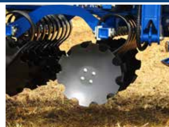
Disque de Ø 515 mm / palier SKF
