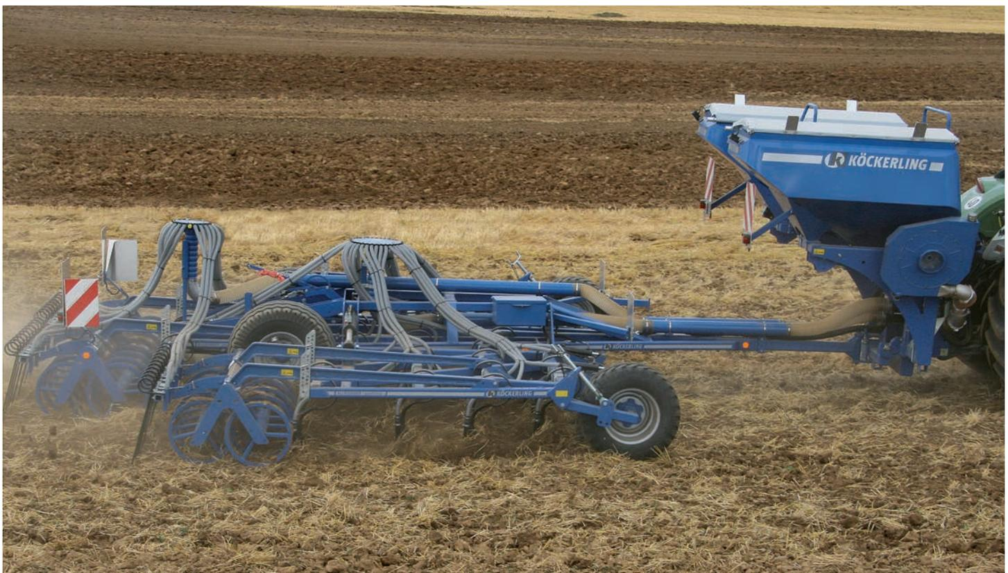
Le BOXER est fréquemment utilisé en combinaison avec un déchaumeur semi-porté. Cette combinaison permet, grâce aux dents du déchaumeur, de réaliser simultanément une fertilisation ciblée à l'avant et un semis sous couvert à l'arrière du rouleau de consolidation.
